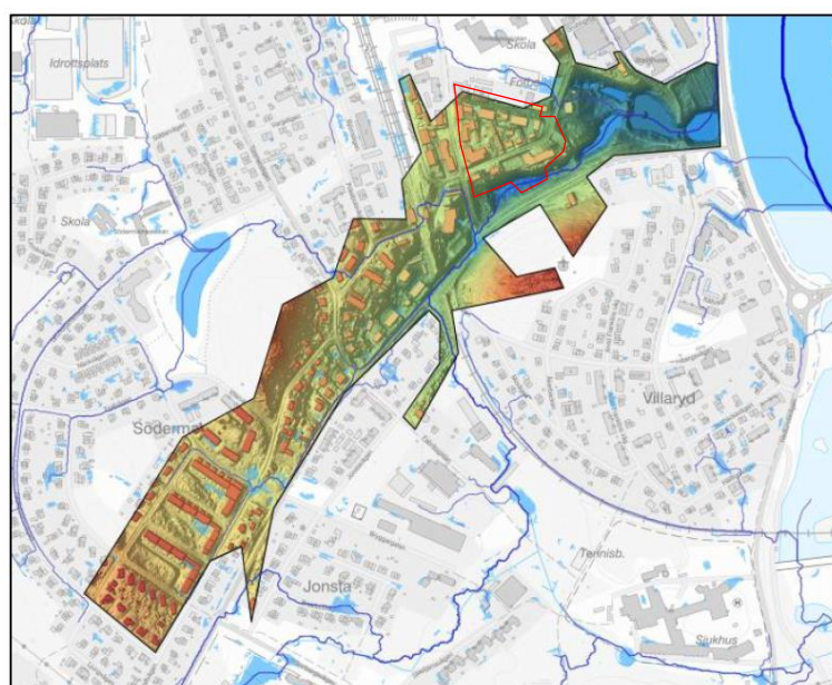
Figur 15. Tillrinningsområde till dagvattendammen vid ett 100-årsregn med en varaktighet på 10 min representeras av större delen av det färgsatta området. Planområde markerat i rött. Bildkälla: Dagvattenutredning ny detaljplan för Tjärhovet 4 och 5, samt för del av Lycksele 10:5 (2024).
