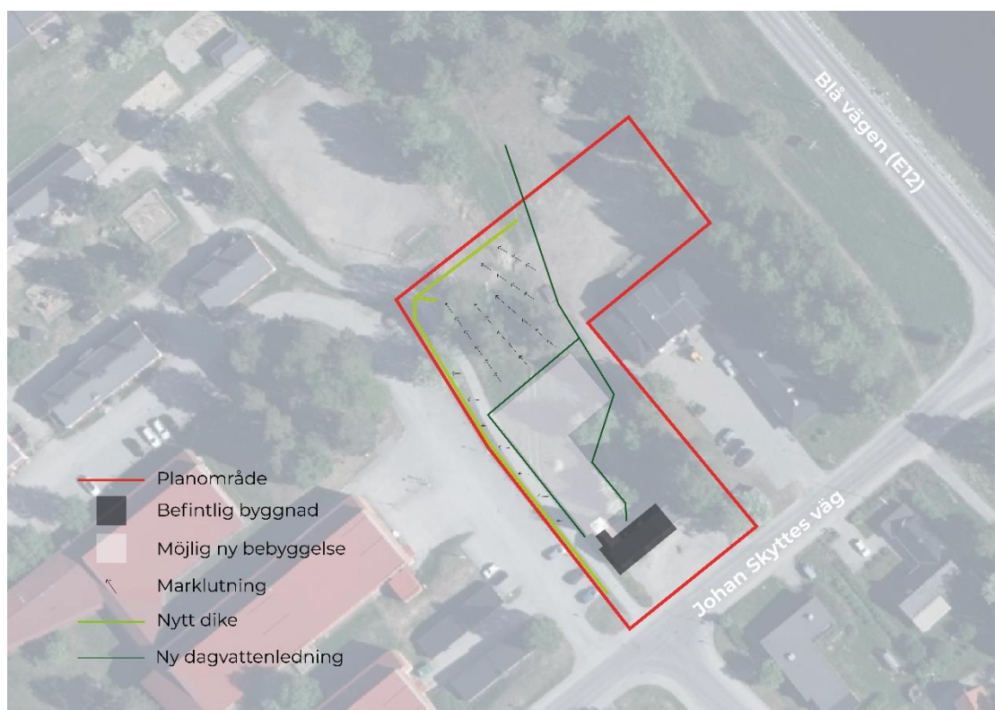
Figur 3. Möjlig dagvattenhantering inom planområdet med nytt dike i ljusgrön och ny dagvattenledning i mörkgrön.
