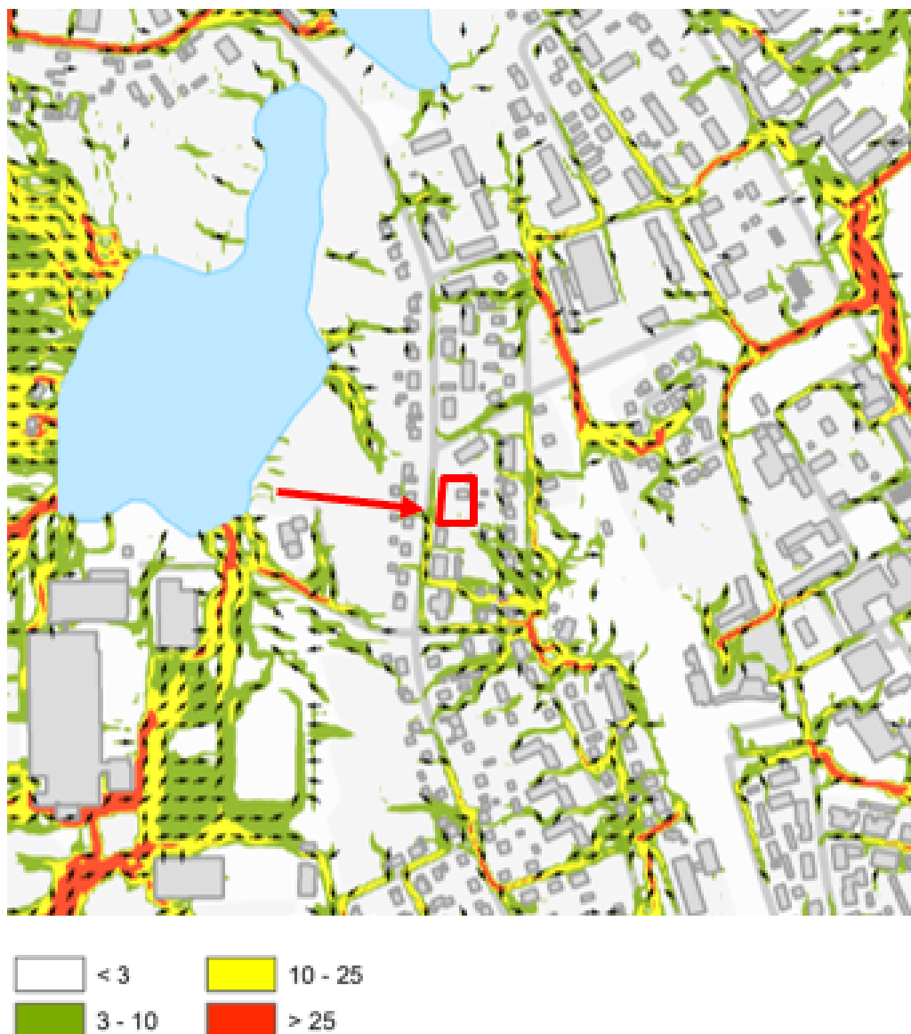
Figur 2: Skyfallskartering som visar flödesriktningar och beräknade maximala flödena (l/s/m) i samband med 100-årsregn. Källa: DHI (2018).
